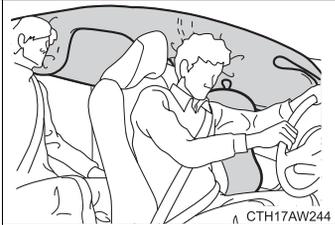
L'airbag latéral SRS et l'airbag rideau SRS ne peuvent fonctionner que lorsque le contact du moteur est en position "ON" (véhicules sans système d'accès et de démarrage mains libres) ou lorsque le contact "ENGINE START STOP" est en mode IGNITION ON (véhicules avec système d'accès et de démarrage mains libres).
