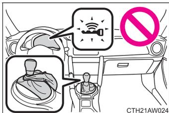
Véhicules équipés d'une transmission automatique: Vérifiez que le levier de vitesses est bien sur P. Le moteur ne peut pas démarrer si le levier de vitesses n'est pas mis sur P. Le témoin indicateur du système d'accès et de démarrage "mains libres" (vert) clignote rapidement.
