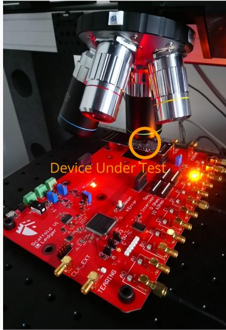
Carte d'attaque (Donjon) et circuit sous le microscope et le faisceau laser
